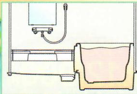
浴槽と浴槽下の防水パンの二重構造でできる断熱空気層が優れた断熱性を発揮。
